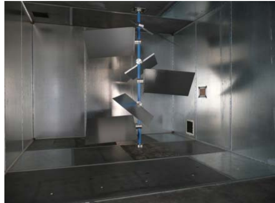
Fig.1 – Brasseur de modes de la CRBM de l'IETR. Dimensions de la cavité : 2.9m x 3.7m x 8.7m.
