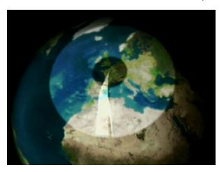
Figure 2: domaine de sondage du radar trans-horizon Nostradamus : une surface annulaire avec un rayon compris entre 900 km et 3000 km au sol
